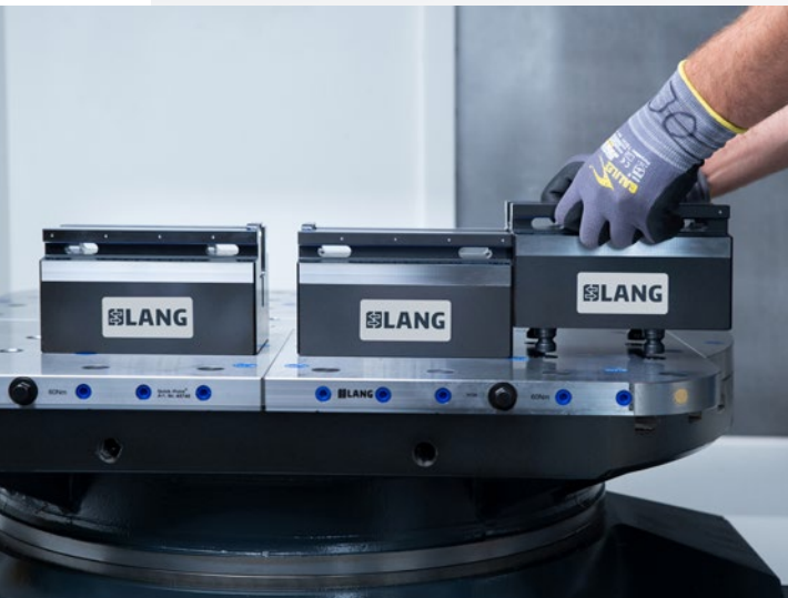
Agrandissement de la plage de serrage grâce à l'ajout de bases monobloc
