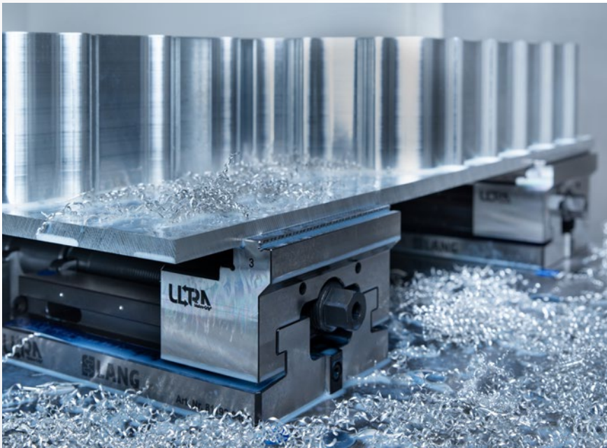
Usinage de pièces brutes avec des mors de serrage dentés Makro-Grip® Ultra.
