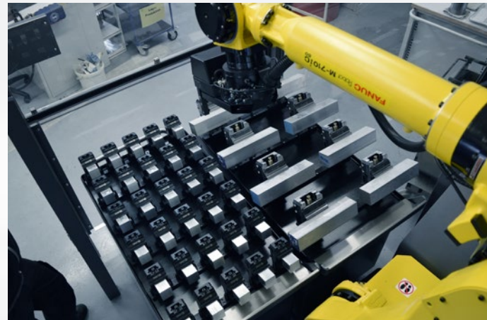
RoboTrex 96 avec interface de changement de pince et différents chariots d'automatisation. Photo : Waibel GmbH CNC-Teilefertigung
