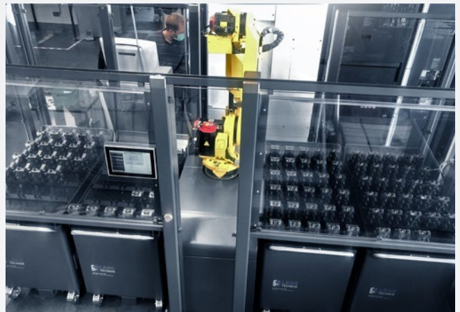
RoboTrex 52 avec quatre chariots d'automatisation sur un système DMU 60evo. Photo : Peter Josef Klein Feinmechanik GmbH
