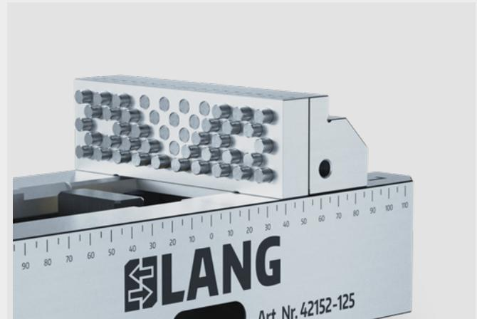
Nicht benötigte Stifte werden einfach per Hand zurückgedrückt. Die übrigen Stifte dienen als Anschlag- und Auflagemöglichkeit für das Werkstück. Parallelunterlagen oder externe Werkstückanschläge, die die Zugänglichkeit negativ beeinflussen, werden somit nicht benötigt.
