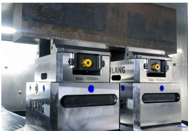
Mit der Doppelprägestation werden Werkstücke geprägt, die anschließend in zwei Schraubstöcken gespannt und bearbeitet werden.
