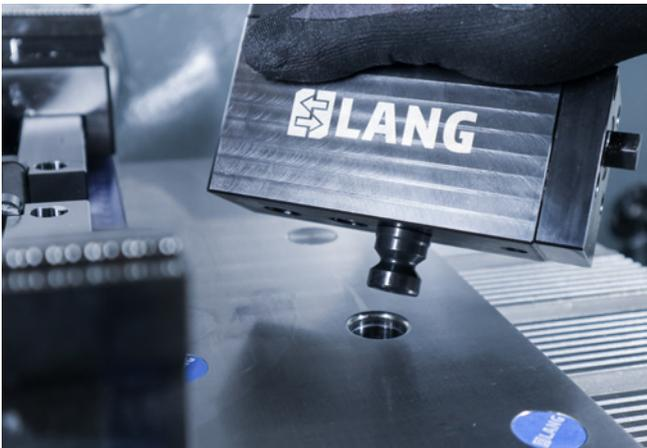
Der Hydro-Sup wird mit seinem Aufnahmebolzen wie andere Spannmittel von LANG im Quick-Point® Nullpunktspannsystem befestigt.
