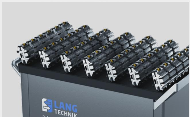
Durch den Einsatz von Mittelbacken in Makro·Grip® 5-Achs-Spannern kann die Speicherkapazität der RoboTrex Automation erhöht werden.
