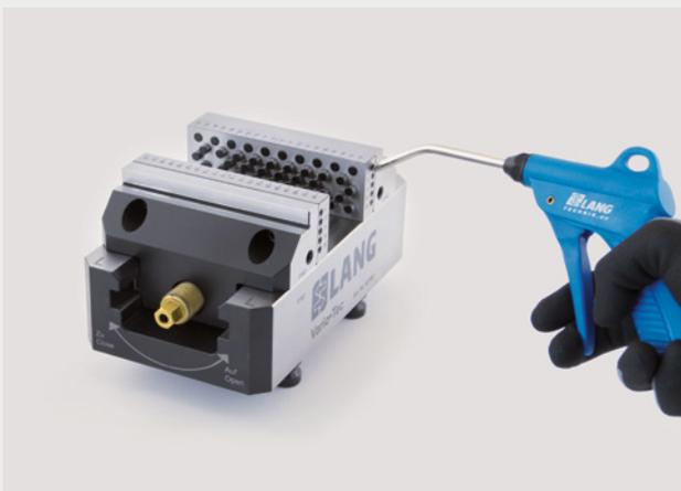
Um die Funktion der Stifte jederzeit zu gewährleisten, sollten diese nach Ende jeder Bearbeitung herausgeblasen und mit Druckluft gereinigt werden, um ein Verharzen durch Kühlmittel zu vermeiden. Das gelegentliche Einsprühen mit Multifunktions-Öl für die Gleitfähigkeit der Stifte ist empfehlenswert.
