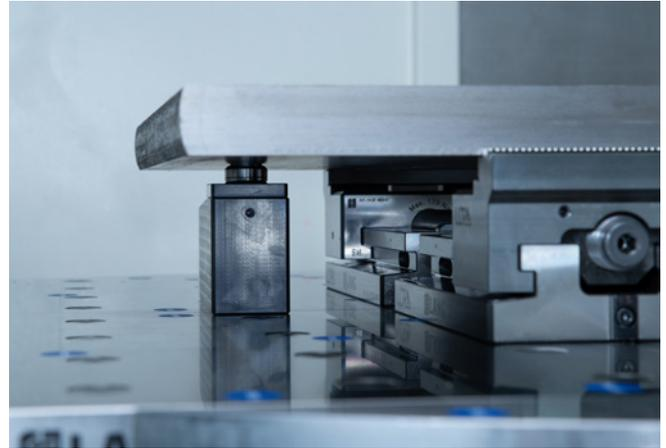
Der hydraulische Schraubbock, der über einen Steckschlüssel bedient wird, passt sich mit seiner Pendelaufgabe an das Werkstück an und mindert Vibrationen, was zu einer erhöhten Oberflächenqualität beiträgt.
