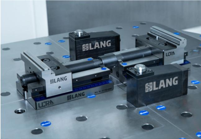
Ein zum jeweiligen Grundkörper passender und in der Höhe mit Distanzkörpern erweiterbarer Schraubbock wirkt unterstützend auf den Spannprozess, was insbesondere bei dünnem Plattenmaterial von hoher Bedeutung ist.
