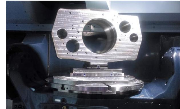
Die Einbringung der Aufnahmebolzen muss im Maß 52/96 mm ± 0,01 erfolgen, um Werkstücke unmittelbar im Quick-Point® System aufzunehmen.
