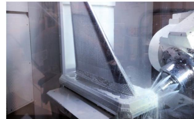
Aluminium-Block (Gewicht: 1.315 kg, Abmessungen: 1.067 × 406 × 1.016 mm) gespannt mit 16 Quick-Point® Aufnahmebolzen über vier Einzelplatten
