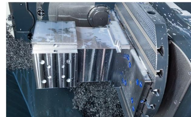
Nicht nur hochpräzise, sondern auch hoch belastbar. Hier zu sehen: Werkstück mit 200 kg Gewicht, 500 mm Höhe. 4 Aufnahmebolzen sind direkt in das Werkstück eingeschraubt.
