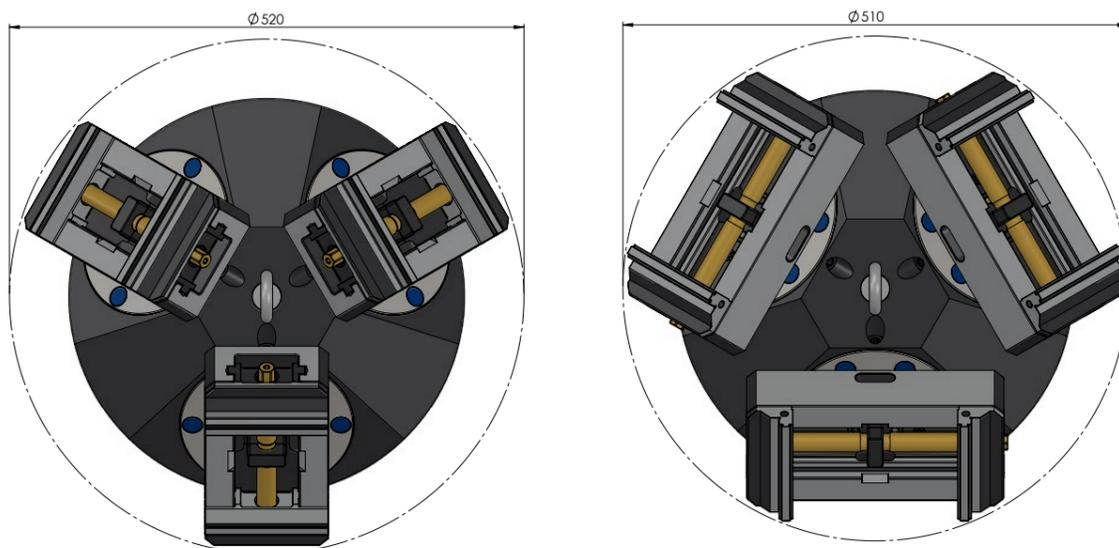
Bei vertikaler Spannung können in der 3-Seiten-Pyramide Makro-Grip® 5-Achs-Spanner 125 mit maximaler Länge von 210 mm gespannt werden (links). Horizontal eingespannt ist eine maximale Schraubstocklänge von 260 mm möglich (rechts).
