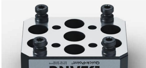
Auf der Unterseite der Quick-Point® 52, 5-Achs-Erhöhen befinden sich Bohrungen zur Montage von Aufnahmebolzen Ø 20 mm zur Verwendung im großen Quick-Point® 96 System.
