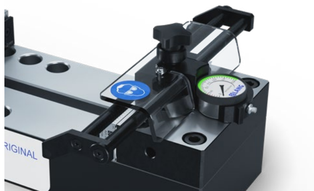
Montierte Zentriereinheit und Prägetiefen-Messvorrichtung auf bestehender Prägestation.
