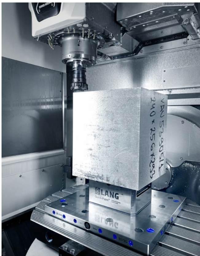
Nicht nur hochpräzise, sondern auch hoch belastbar. Vier Aufnahmebolzen sind direkt in das Werkstück mit etwa 50 kg eingeschraubt.
