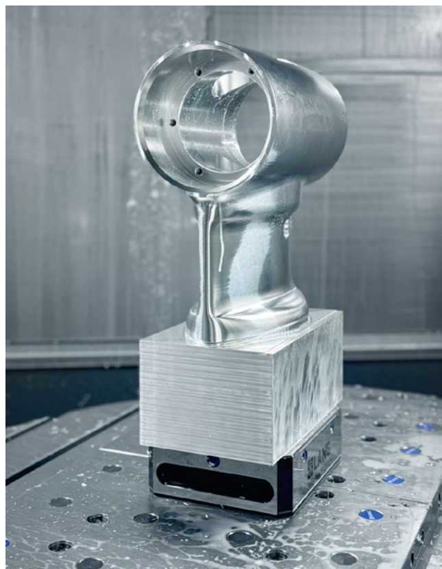
Direktspannung einer Getriebebox über vier Aufnahmebolzen mit über 80% Materialabtragung.
