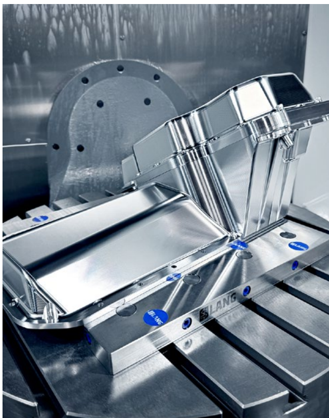
Ölwanne aus dem Motorsportbereich, die für ihre Bearbeitung in einer Mehrfach-rasterplatte über Aufnahmebolzen gespannt wurde.
