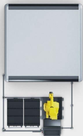
Beladung durch die Maschinentür
