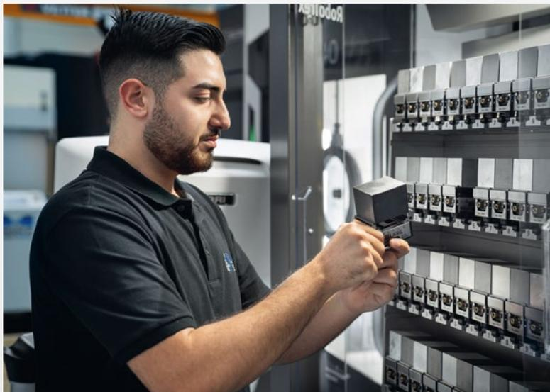
Encore moins encombrant, encore plus d'étaux sur une petite surface, encore plus rentable. Le nouveau système d'automatisation RoboTrex Compact réunit tous les avantages de son « grand frère », mais il est spécialement conçu pour les applications dans le domaine des petites pièces. Le robot Fanuc intégré transporte des composants pesant jusqu'à 7 kg de leur magasin à la machine-ou-
