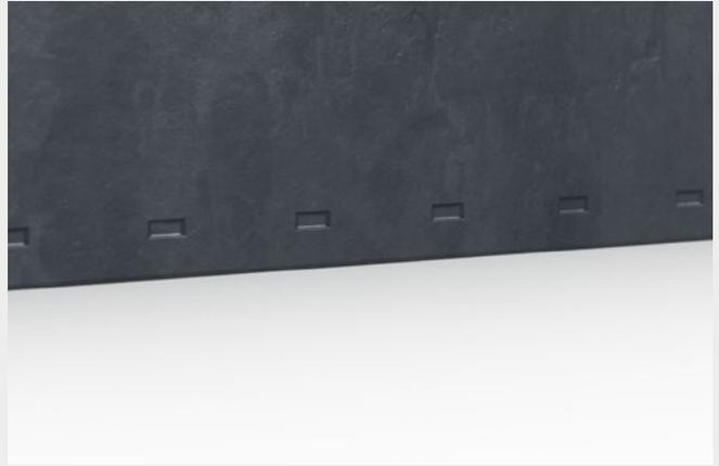
Pour les matériaux d'une résistance à la traction supérieure ou égale à 1 100 N / mm<sup>2</sup>, la profondeur de l'empreinte de contrôle ne doit pas être visible. La profondeur de l'empreinte de la dent de marquage est d'environ 0,10 mm.
