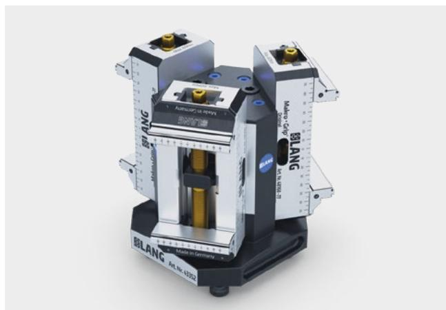
En montage vertical, il est possible d'obtenir une longueur d'étau maximale de 170 mm. Des longueurs plus courtes et des tailles plus petites peuvent bien sûr être utilisées.
