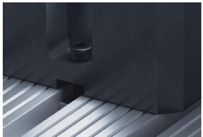
Si la structure inférieure doit rester en permanence sur la table de la machine, une fixation directe dans les rainures de la table de la machine apparaît comme la meilleure solution. Dans ce cas, il est possible d'économiser une plaque point zéro et sa hauteur de montage de 27 mm.
