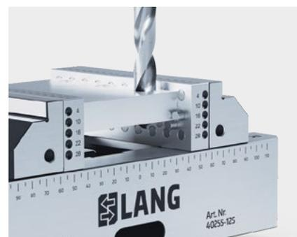
Les pions non nécessaires sont simplement repoussés à la main. Les pions restants servent de possibilité d'arrêt et de support pour la pièce à usiner. Les supports parallèles ou les butées de pièces.
