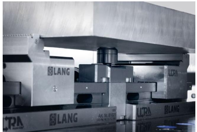
La tige de commande est actionnée par un six pans creux. Celle-ci permet de régler la hauteur d'appui du support mécanique de 28,5 mm minimum à 42,5 mm maximum.
