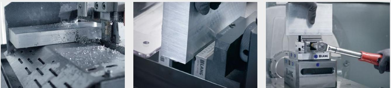
En quelques étapes, le pré-marquage d'une pièce brute permet d'obtenir une valeur ajoutée considérable pour le serrage de la pièce. Le processus de marquage dure moins de cinq secondes et ne nécessite pas de capacité machine supplémentaire. Le marquage s'effectue directement sur la trace de scie ou sur la couche de cala-
