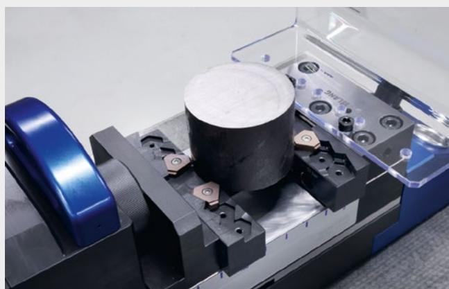
La technique de marquage est prédestinée aussi bien pour les pièces brutes cylindriques que cubiques (deux surfaces parallèles) et est applicable à tous les matériaux non fragiles. Les matériaux exclus sont par exemple le graphite, les fibres composites comme le car-
